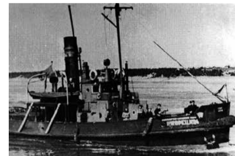
Буксирный винтовой пароход типа «Ижорец»
